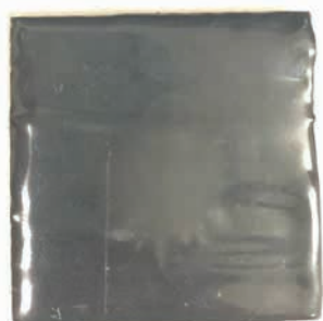
Fot. 3b. Próbkę kompozytu Belzona 2141®. Widok po ekspozycji
