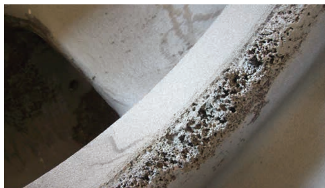
Fot. 5. Wżery kavitacyjne w warstwie wierzchniej korpusu pompy
