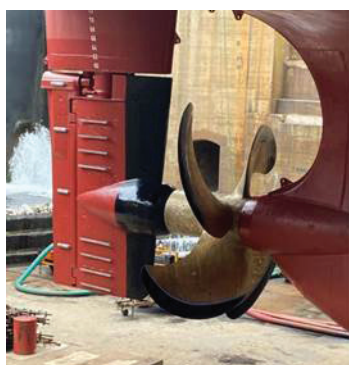
Fot. 4. Powłokę Belzona 2141® zastosowaną do ochrony przed kavitacją steru i śruby okrętowej
