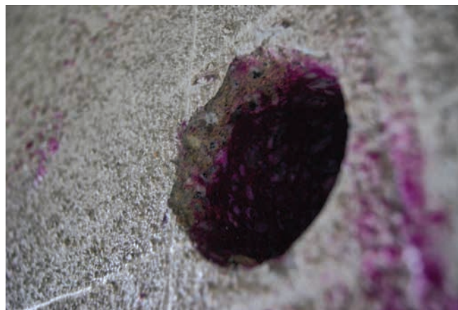
Fot. 4. Otwór po pobraniu rdzenia poddany badaniu zasięgu karbonatyzacji fenolofaleiną. Głębokość strefy zobojętniałej wynosi 20 do 30 mm.
