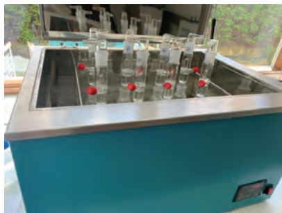
Rys. 1. Aparatura do oznaczania stopnia gazowania pigmentów cynkowych
