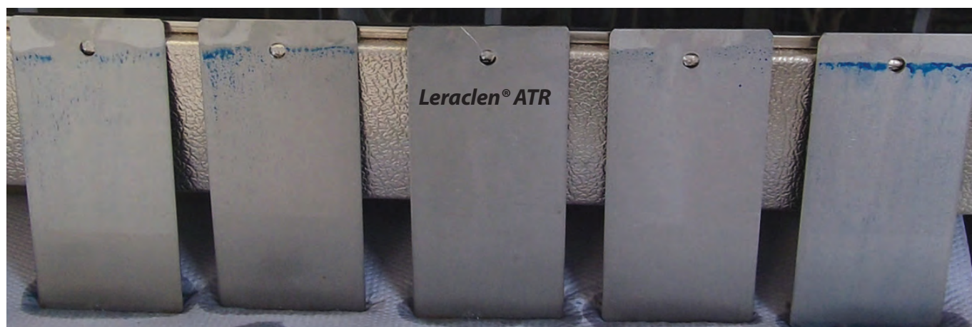
Rys 1. Odtłuszczanie w temperaturze 30°C dla różnych systemów odtłuszczających. Czas zanurzenia w kąpeli – 10 minut
