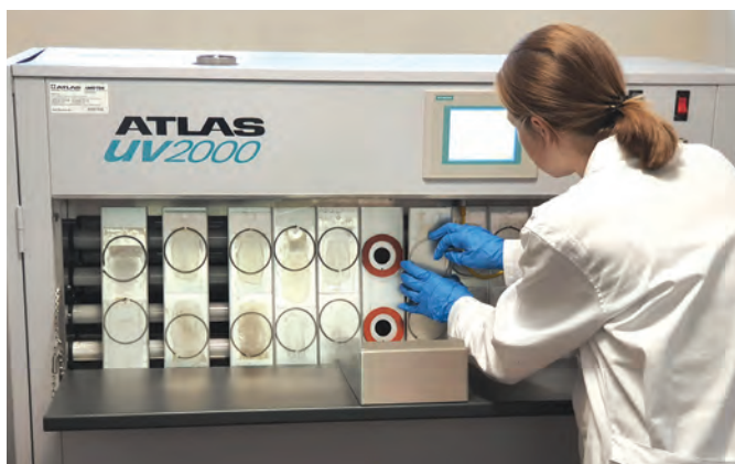
Fot.1. Badania cykliczne z wykorzystaniem promieniowania UV oraz kondensacji wody na próbkach
