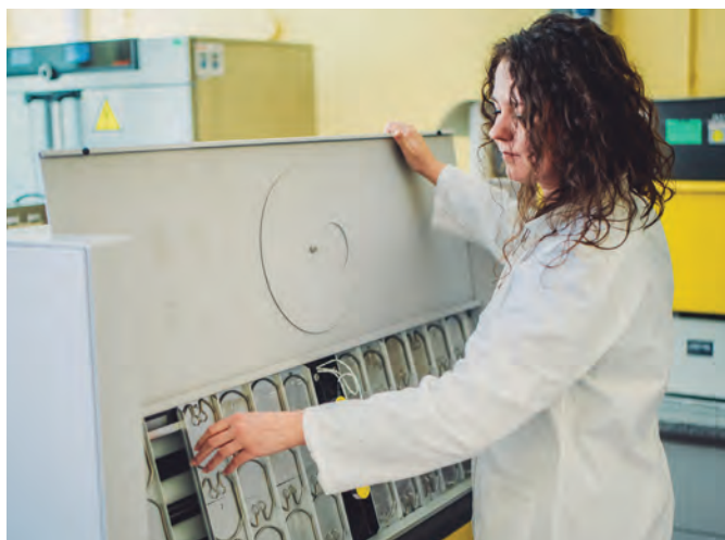
Komora z lampami fluorescencyjnymi do badania odporności powłok na UV
