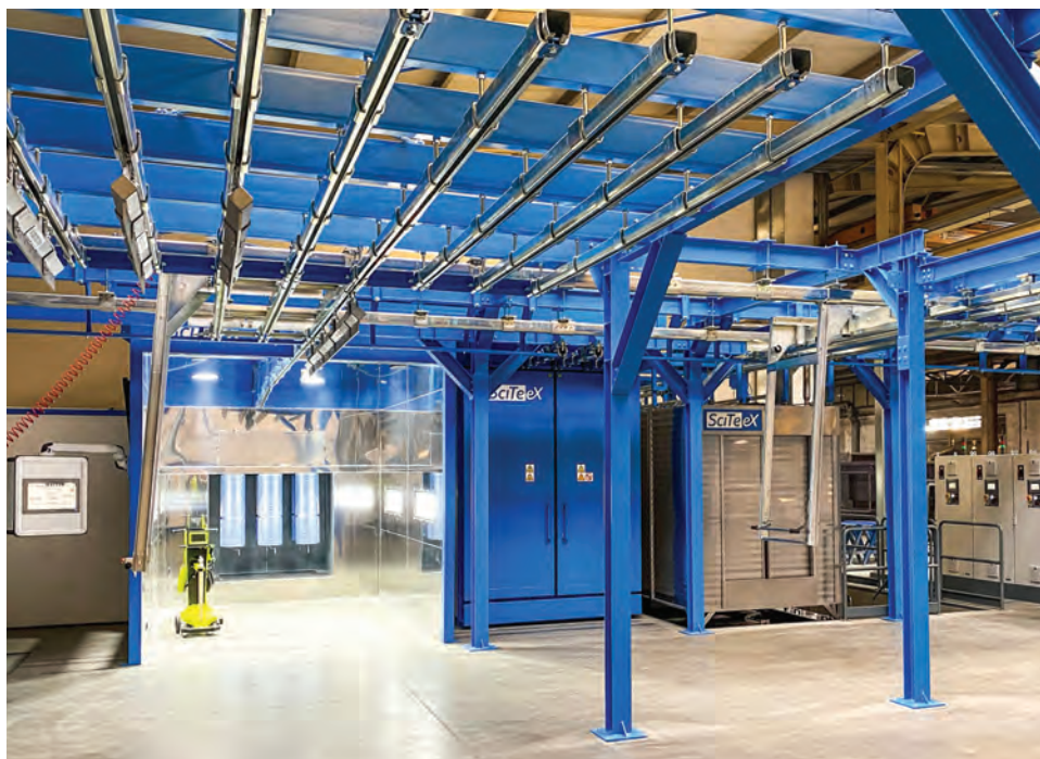
Linia do malowania proszkowego według koncepcji RUBICOAT®
