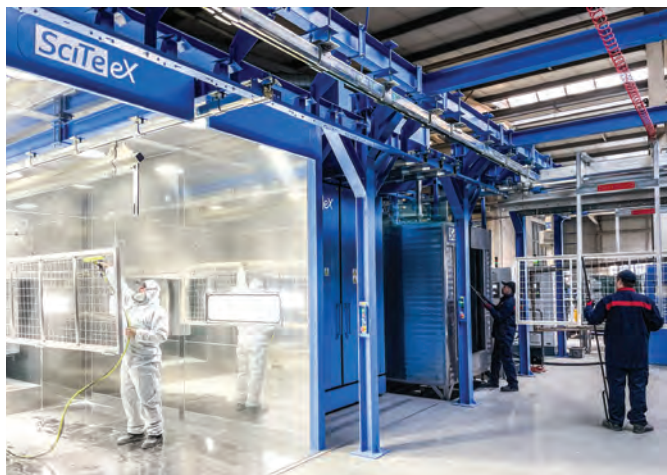
Linia do malowania proszkowego według koncepcji RUBICOAT®
