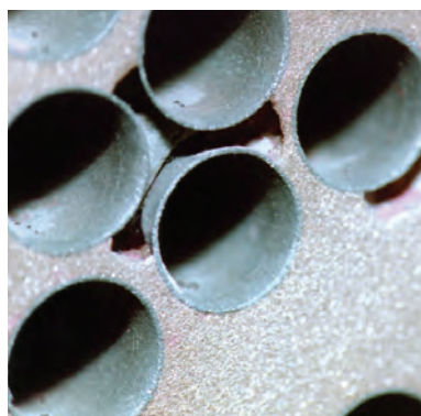
Fot. 3. Korozja elektrochemiczna – wżery korozyjne na styku rurki i dna sitowego
