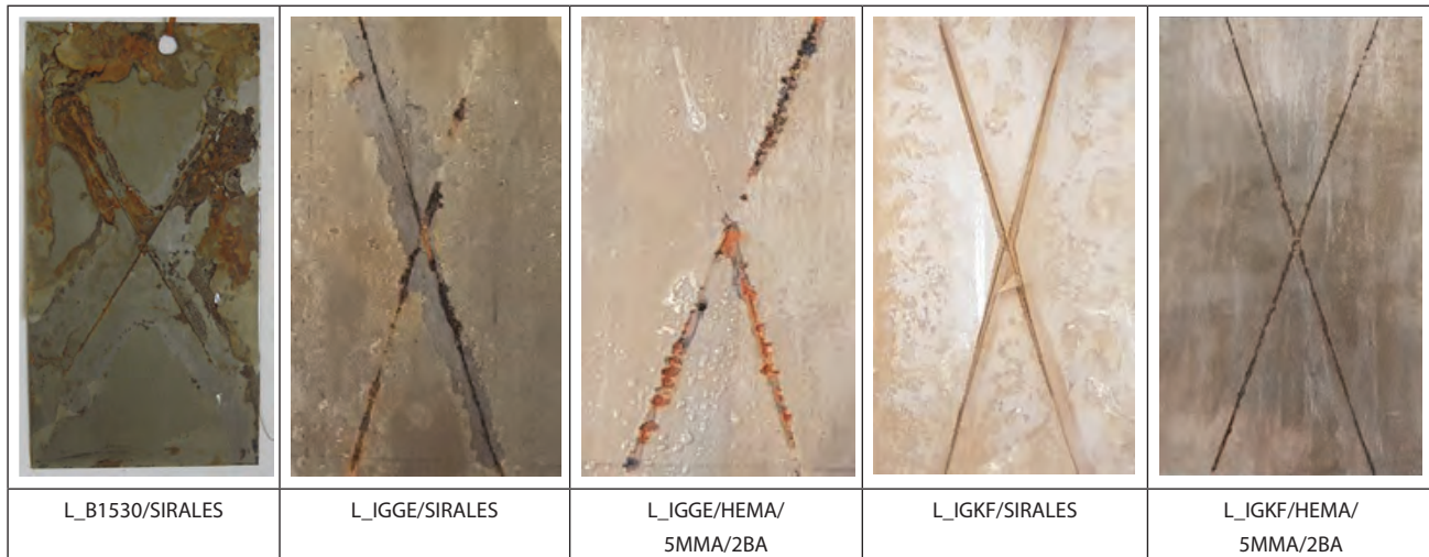
Rys. 4. Wygląd powłok po 720 h testu zanurzeniowego w 3,5% roztworze NaCl Fig. 4. Appearance of coatings after 720 h immersion test in 3.5% NaCl solution
