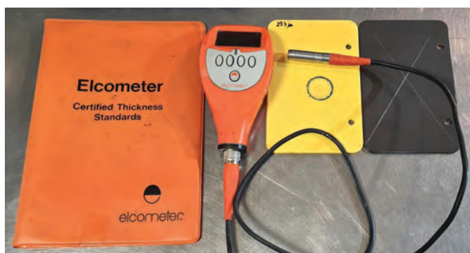
Fot. 5. Pomiar grubości powłok ochronnych certyfikowanym sprzętem
