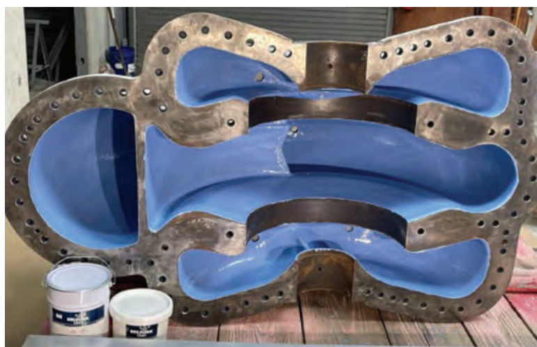
Fot. 1. Pompa z zastosowaną powłoką kompozytową Belzona® 1341
