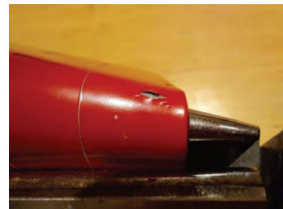
Rys. 6. Pęknięcie w warstwach akrylowych (nawierzchniowej i pośredniej) na skutek zginania powłoki akrylowo-epoksydowej starzonej promieniowaniem UV przez 1344 h
