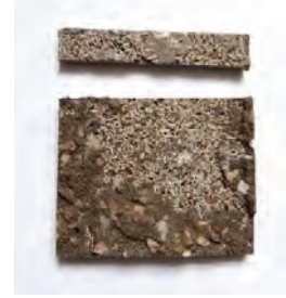
Fot. 3. Próbkę pobraną z miejsca, gdzie stwierdzono prawidłową przyczepność do podłoża.
