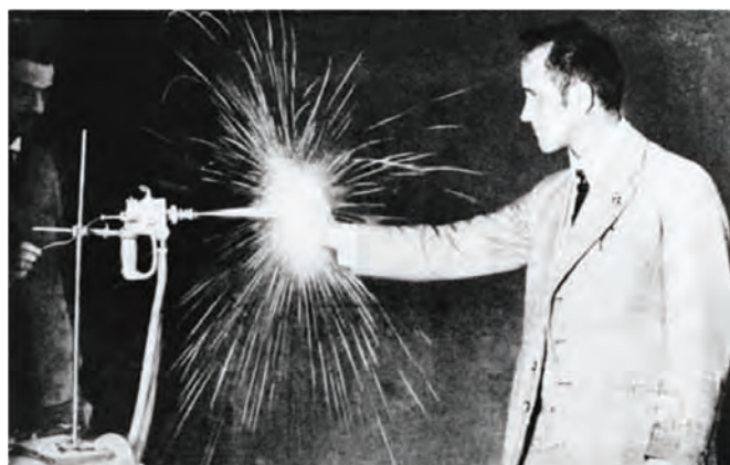
Fot. 25. Max Ulrich Schoop demonstruje do jak niskiej temperatury nagrzewa się podłoże podczas metalizacji [11]
