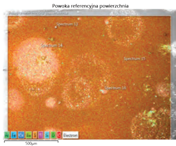
Fot. 18. Rozkład pierwiastków na powierzchni próbki referencyjnej.
