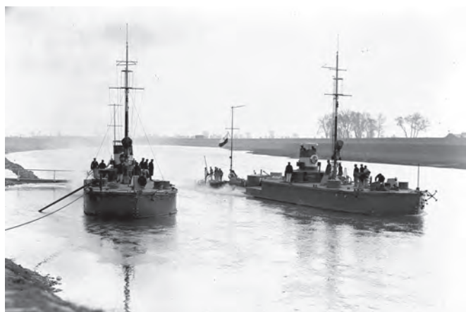
Fot. 26. Monitory rzeczne ORP „Wilno” i ORP „Kraków”. Kadłuby takich jednostek były cynkowane metodą metalizacji natryskowej w stoczni w Modlinie.
