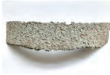
Fot. 2. Próbkę pobraną z miejsca, gdzie stwierdzono obniżoną przyczepność do podłoża.
