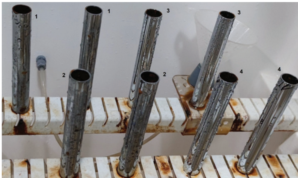
Rys. 2. Detale po 120 h w komorze solnej, wg PN-EN ISO 9227:2017-06. 1 – detale pokryte powłoką powstałą z chrom(III) w skali laboratoryjnej w firmie Galvano-Partners; 2 – detale pokryte produkcyjnie powłoką powstałą z chrom(III); 3 – detale pokryte powłoką z elektrolitu chromu(VI) produkcyjnie; 4 – detale sprawdzające – z partii, której wyniki były znane wcześniej
