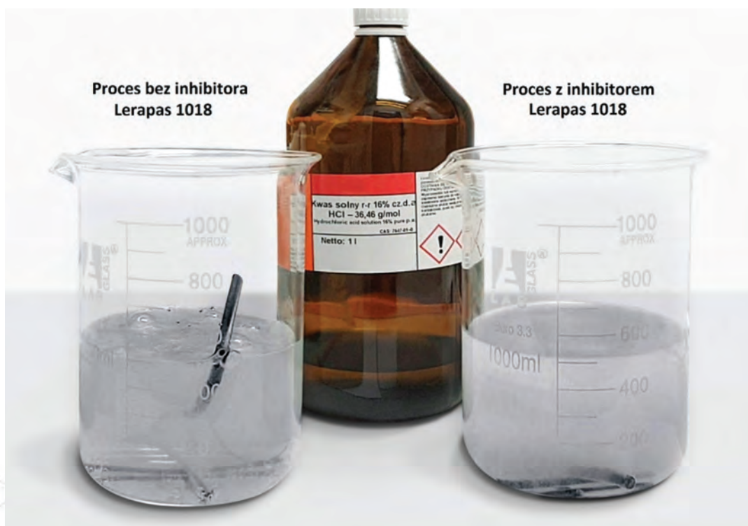
Przebieg reakcji trawienia w kwasie solnym bez dodatku inhibitora (po lewej) oraz z dodatkiem Lerapas® 1018 (po prawej)
