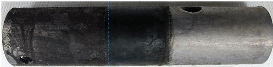
Rys. 3. Porównanie TIB Clean A300 ze standardowym odtłuszczeniem kwaśnym: standardowe odtłuszczenie kwaśne, 15 min w 25°C (po lewej), nieczyszczona powierzchnia referencyjna (na środku), odtłuszczenie TIB Clean A300 , 15 min w 25°C (po prawej)
