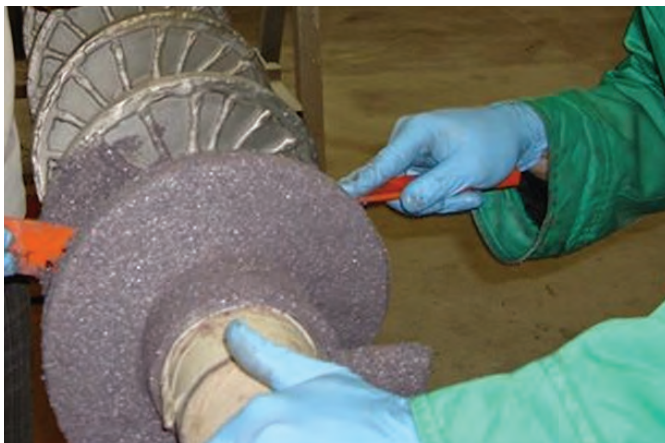
Fot. 8. Zabezpieczenie przed wycieraniem powierzchni podajnika ślimakowego kompozytem Belzona®1812
