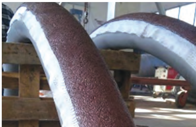
Fot. 5. Zabezpieczenie zewnętrznej krzywizny kolana pyłoprzewodu kompozytem Belzona®1812
