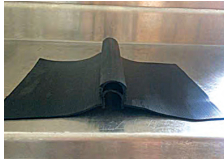
Fot. 1. Taśmy uszczelniające z plastyfikowanego polichlorku winylu przeznaczone do badania w warunkach laboratoryjnych
