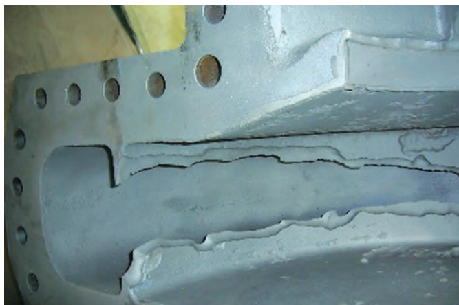
Fot. 1. Erozyjne zniszczenie ostrogi korpusu pompy wirowej
