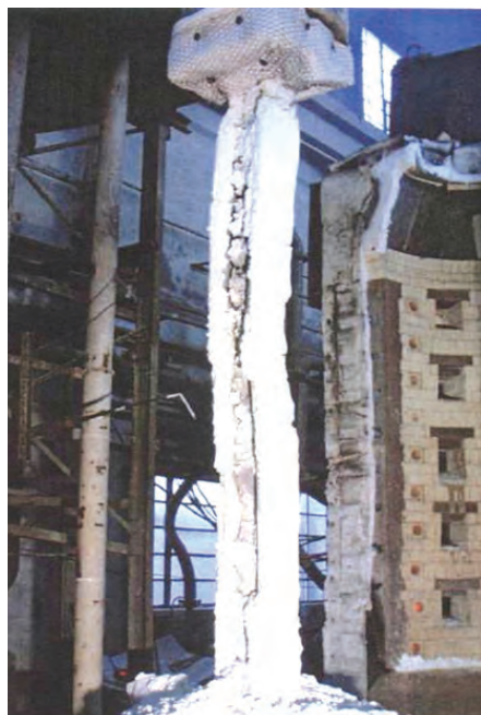
Stalowy słup dwuteowy zabezpieczony powłoką pęczniącą po badaniu odporności ogniowej
