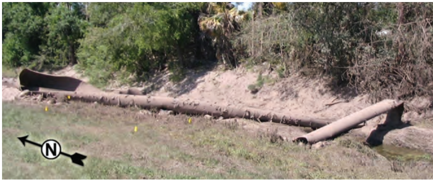
Rys. 1. Przykłady rozerwania gazociągów spowodowanych przez SCC [5, 7]. Dzięki uprzejmości U.S. NTSB, TSB of Canada
