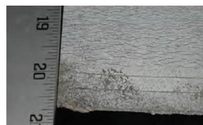
Rys. 8. Kolonia naprężeniowych pęknięć korozyjnych [10, 15]. Dzięki uprzejmości UKOPA
