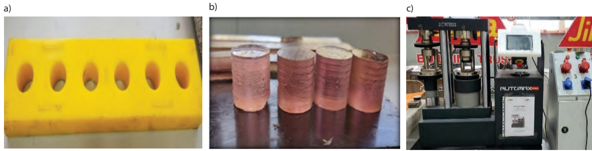
Fig. 1. Compressive strength test: a) mold used to prepare the samples, b) shape of the samples, c) device used to measure compressive strength Rys. 1. Pomiar wytrzymałości na ściskanie: a) forma użyta do przygotowania próbek, b) kształt próbek, c) urządzenie pomiarowe
